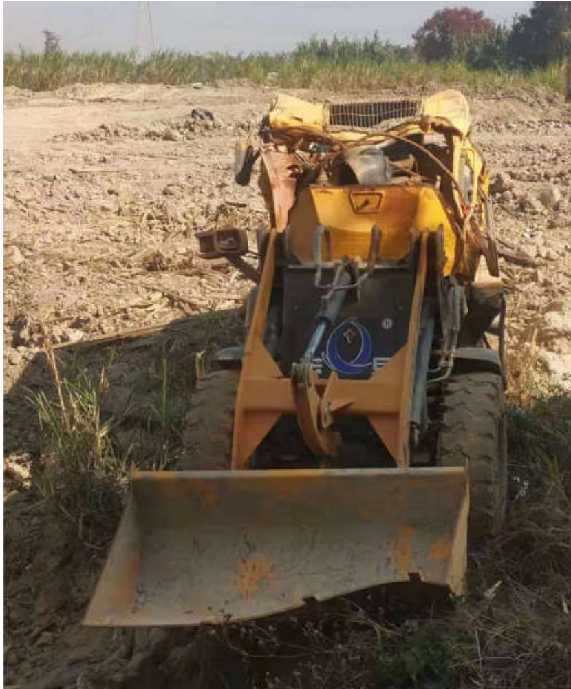
图 2 事故涉及装载机的驾驶室已完全被挤压变形（正视图）
