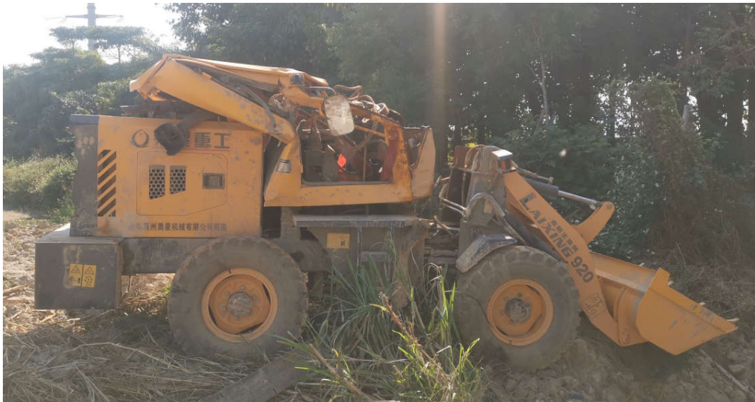
图 2 事故涉及装载机的驾驶室已完全被挤压变形（侧视图）
