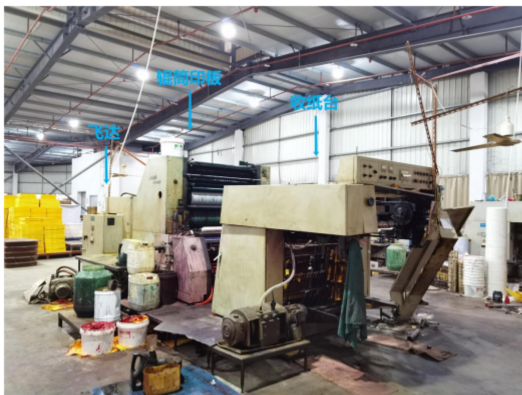
图 1-1 涉事对开双色平板印刷机 (因救援需要，“收纸台”已拆机顶)
